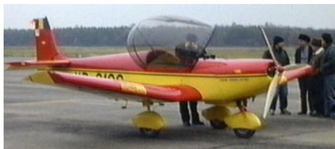
greutate maximă la decolare: 450 kg; lățime cabină: 1120 cm; capacitate rezervor principal: 60 litri; capacitate rezervoare suplimentare: 2x27
